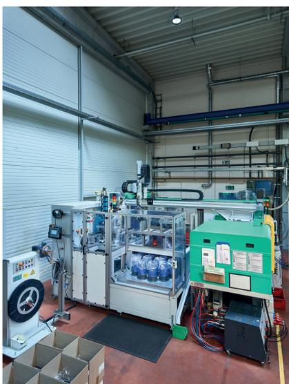
**Bild 2.** Mit der kompakten Turnkey-Anlage fertigt Goerlich für die Automobilindustrie Gehäuse für Unterdrucksensoren effizient und flexibel © Arburg
